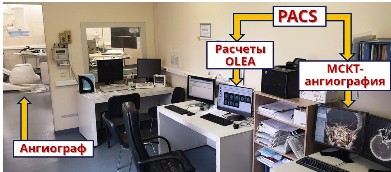
**Рисунок 5** – Кабинет управления ангиографической установки «General Electric Innova 3100IQ» с рабочей станцией ангиографа. «Желтой» стрелкой указан процесс автоматической передачи данных МСКТ из архива PACS на рабочую станцию ангиографа для интраоперационного анализа полученных изображений рентгенэндоваскулярным хирургом
